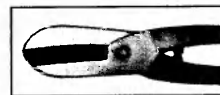
Прямые ножницы по металлу для резания по прямой и внешним закруглениям.
