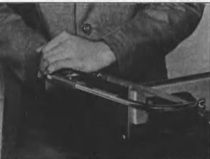
При большой длине пропила полотно ножовки поворачивают на 90°.
